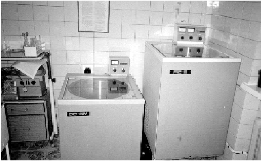
Рис. 19. Рефрижераторна центрифуга ОС-6 для проведення апаратного гравітаційного плазмаферезу.
